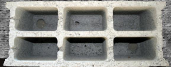
Parpaing : 20x50cm, 2 trous pour tiges métalliques, et 2 extrémités tronquées pour mettre du mortier.
